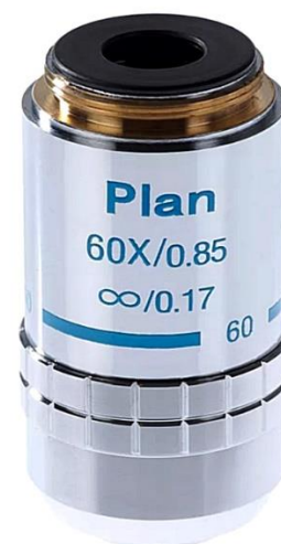
Планахромат 60 крат, с числовой апертурой 0,85 и полезным увеличением до 850крат, с бесконечным тубусом, с максимальным ограничением по толщине покровного стекла в 0.17мм
